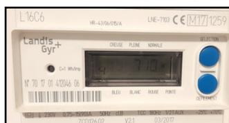
Appuyez sur « Sélection » jusqu'au n° 4, puis « défilement »
